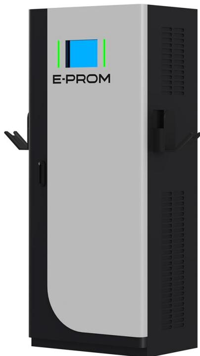
Зарядная станция для электромобилей E-PROM60 с фирменным уникальным компактным дизайном, предназначена для заряда электротранспорта постоянным током с выходной мощностью до 60кВтс применением двух видов разъемов CCSCCombo2 и GB/T (в стандартном исполнении) и динамической балансировкой мощности, при одновременной зарядной сессии двух электромобилей.
